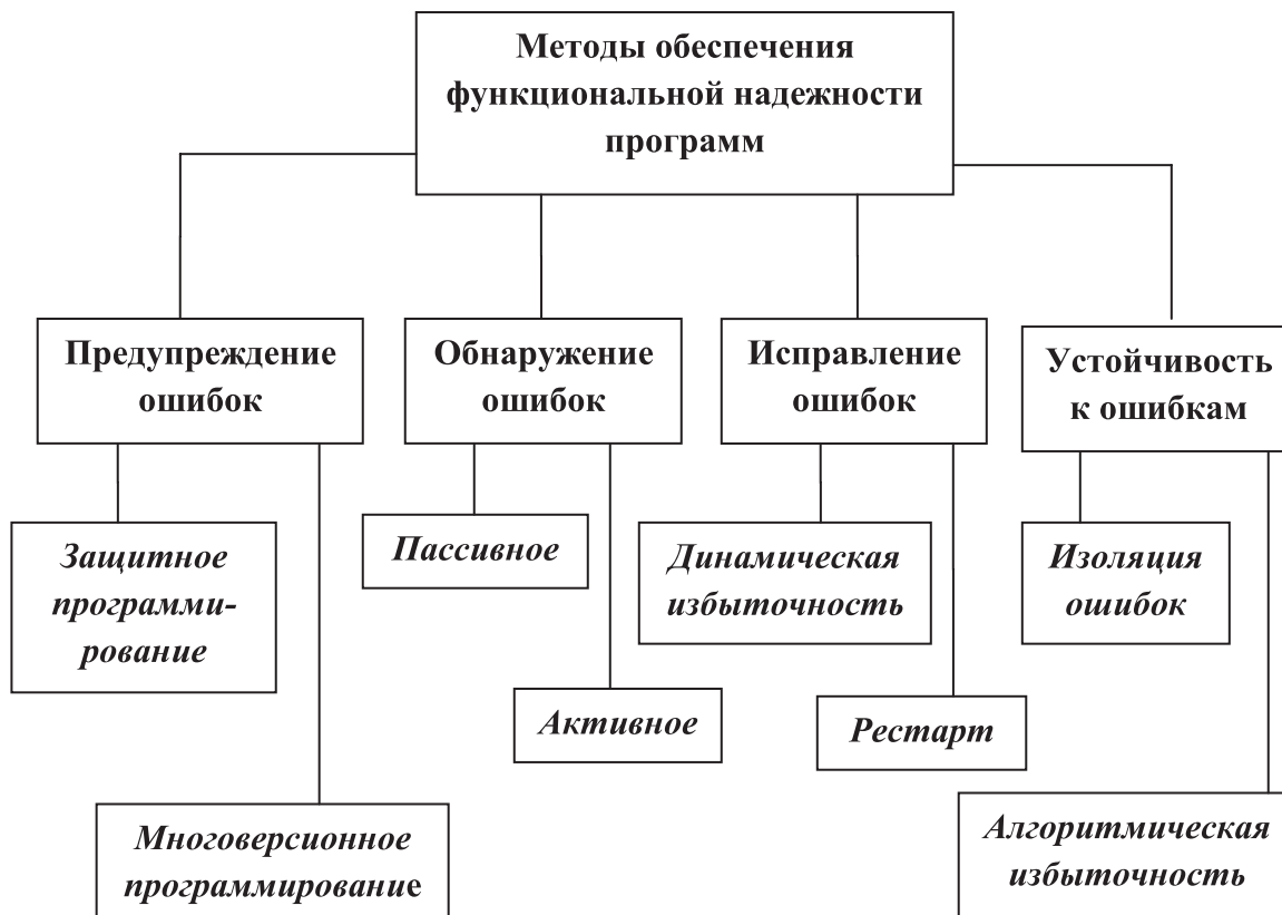
Рис. 1. Основные аспекты построения архитектуры надежного программного обеспечения
