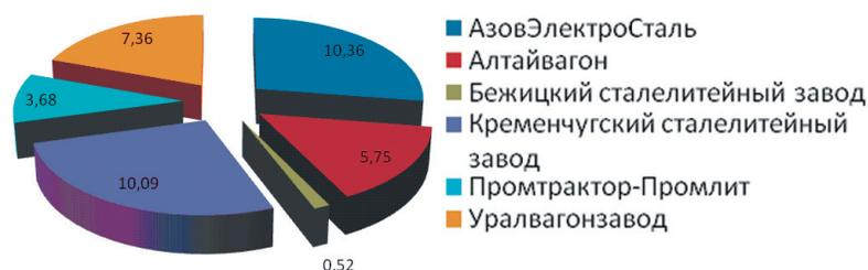
Рис. 4. Прогнозируемое на 2014 г. количество изломов боковых рам (по изготовителям)
