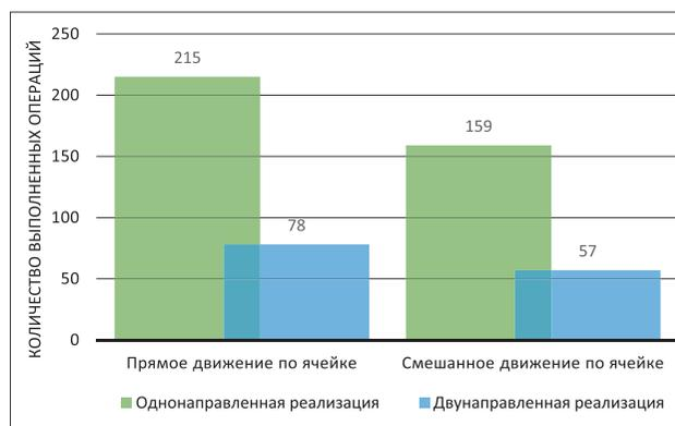
Рис. 4. Результаты экспериментов с различными вариантами реализации алгоритма поиска в ширину (Breadth-First Search, BFS), по показателю «Количество выполненных операций»
