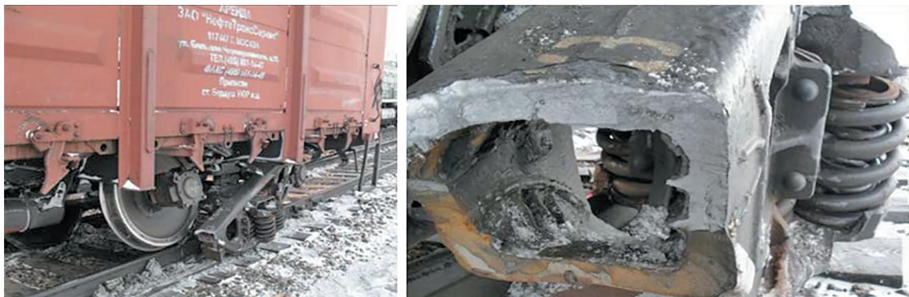
Рис. 4. Авария в грузовом поезде по причине излома боковой рамы тележки вагона
