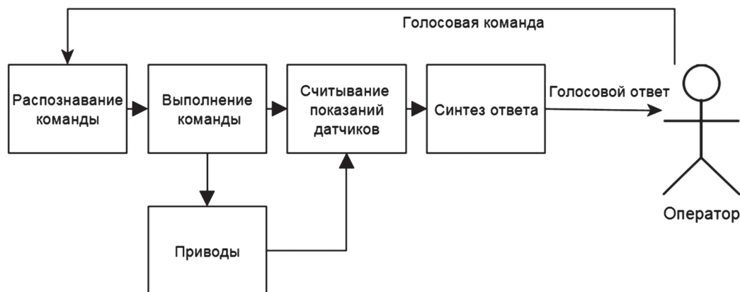
Рис. 1. Последовательная структура встраиваемой микропроцессорной системы управления медицинским роботом
