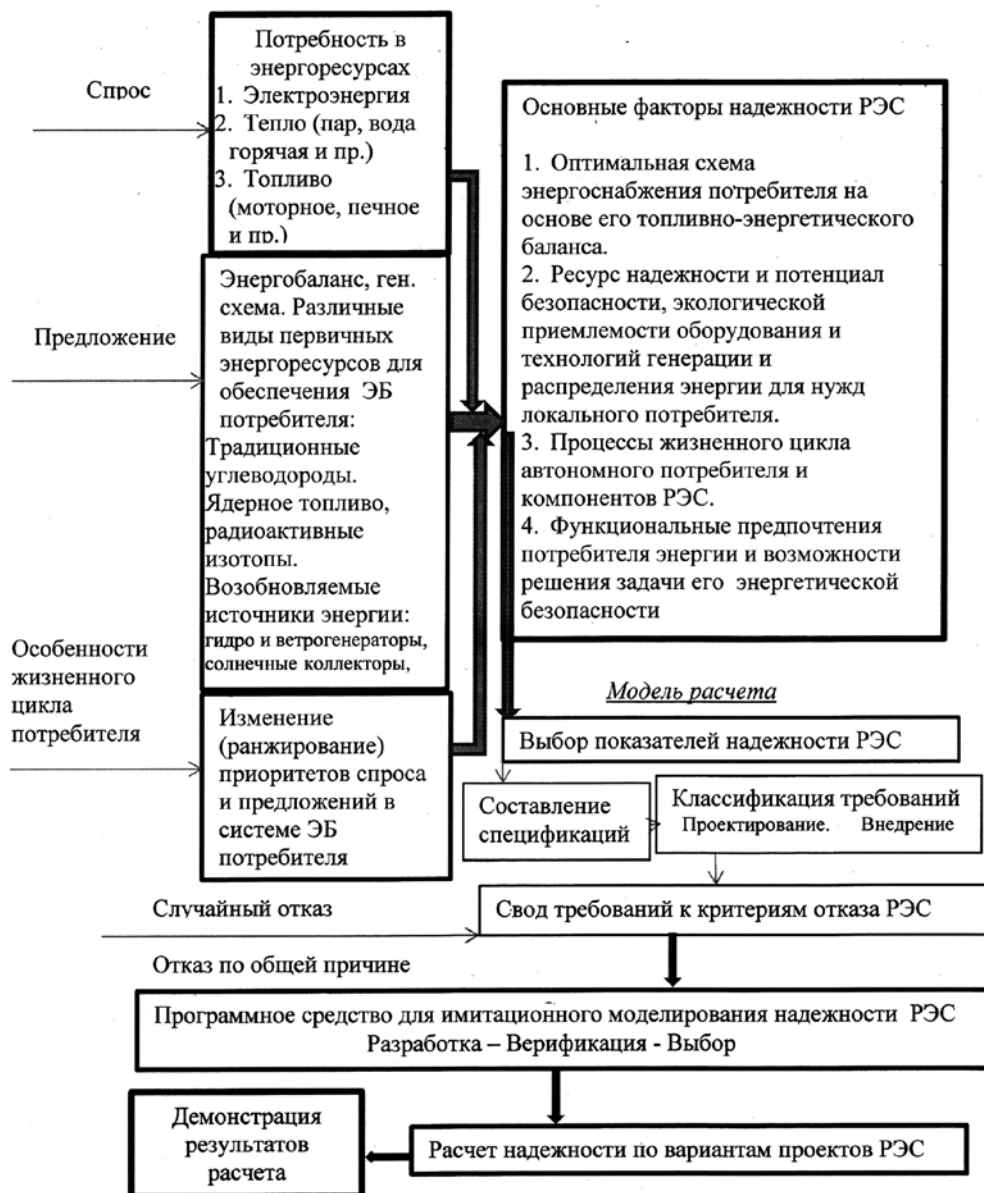
Рис. 2. Модель концепции прогнозной оценки надежности РЭС.
