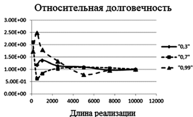
Рис. 2. Стабилизация вычисленной относительной долговечности с увеличением длины реализации для процессов, показанных на рис. 1 (а–в)
