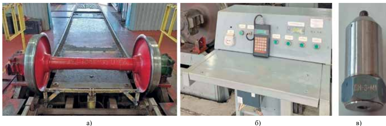
Рис. 1. Установка УДП-2001СМ: а) стенд для раскрутки КП; б) пульт управления стендом с устройством вибродиагностики; в) преобразователь пьезоэлектрический виброизмерительный ДН-3-М1
