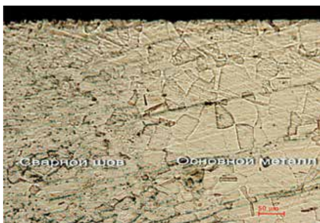
Рис. 4. Структура приповерхностного слоя контролируемой поверхности сварного образца, вырезанного из корпуса реактора, в месте перехода от основного металла к сварному шву
