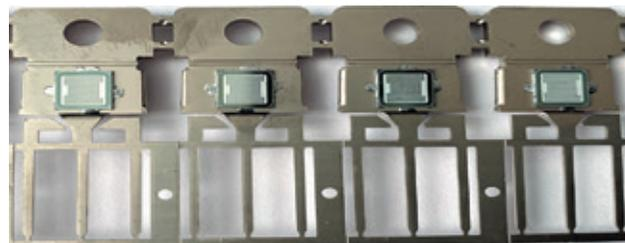
Рис. 1. Посадка кристалла на основание корпуса
