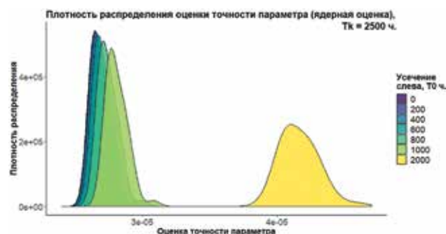
Рис. 9. Результаты оценки точности параметра интенсивности отказа распределения Вейбулла методом МФР в зависимости от момента начала наблюдения T_0 . T_k = 2500 ч.
