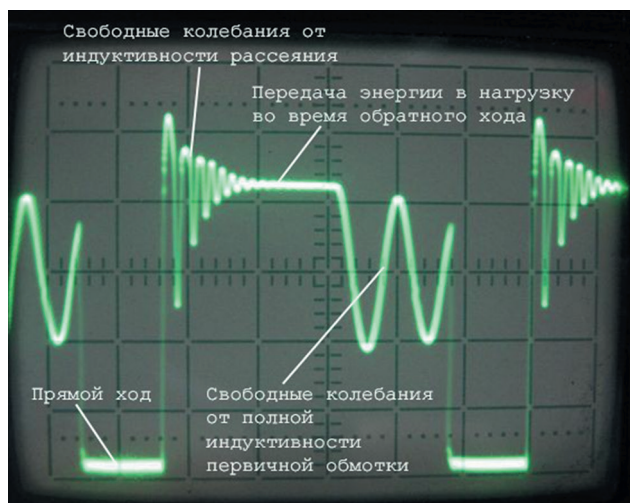
Рис. 1. Искажения импульса обратноходового преобразователя
