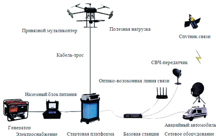
Рис. 1. Состав и схема применения привязного мультикоптера
