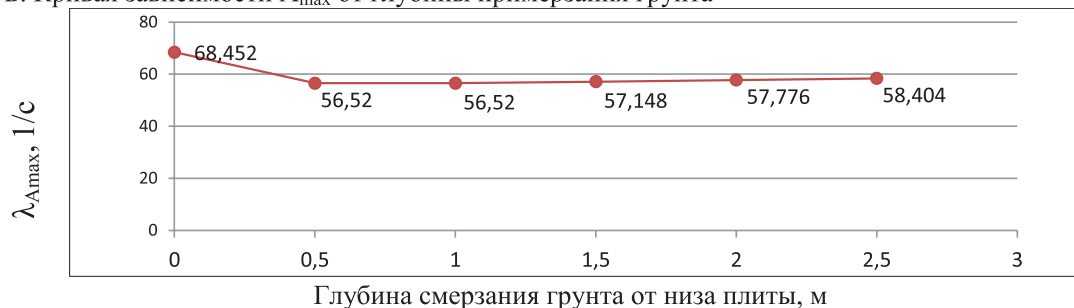
В. Кривая зависимости \lambda_{A_{max}} от глубины смерзания грунта
