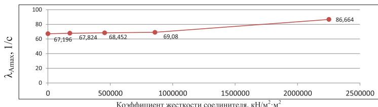
Г. Кривая зависимости \lambda_{A_{\max}} от коэффициента жесткости соединительных элементов
