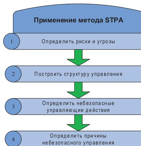
Рис. 2. Последовательность применения метода STPA
