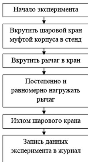
Рис. 3. Алгоритм проведения эксперимента
