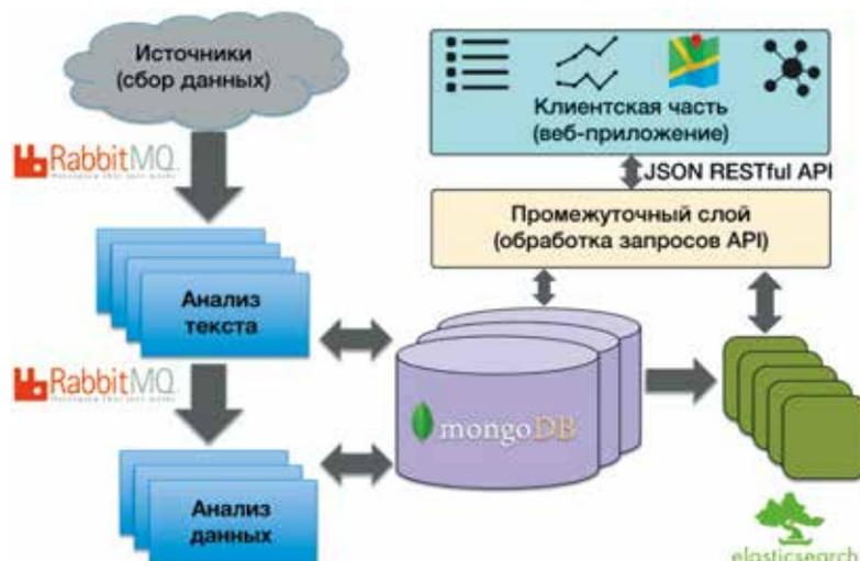
Рис. 7. Техническая архитектура системы с точки зрения потока данных
