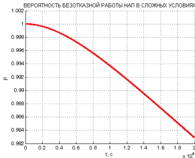
Рис. 2 – Вероятность безотказной работы НАП (с нагруженным резервом) в сложных условиях для трех дополнительных модулей противодействия
