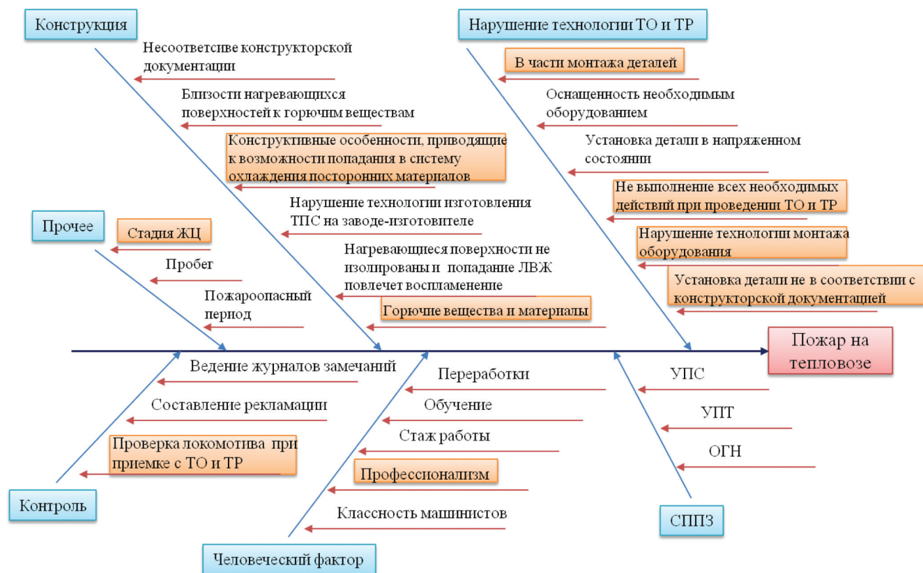
Рисунок 4 – Причинно-следственные связи пожаров на тепловозах и электровозах и факторов, влияющих на возникновение пожара
