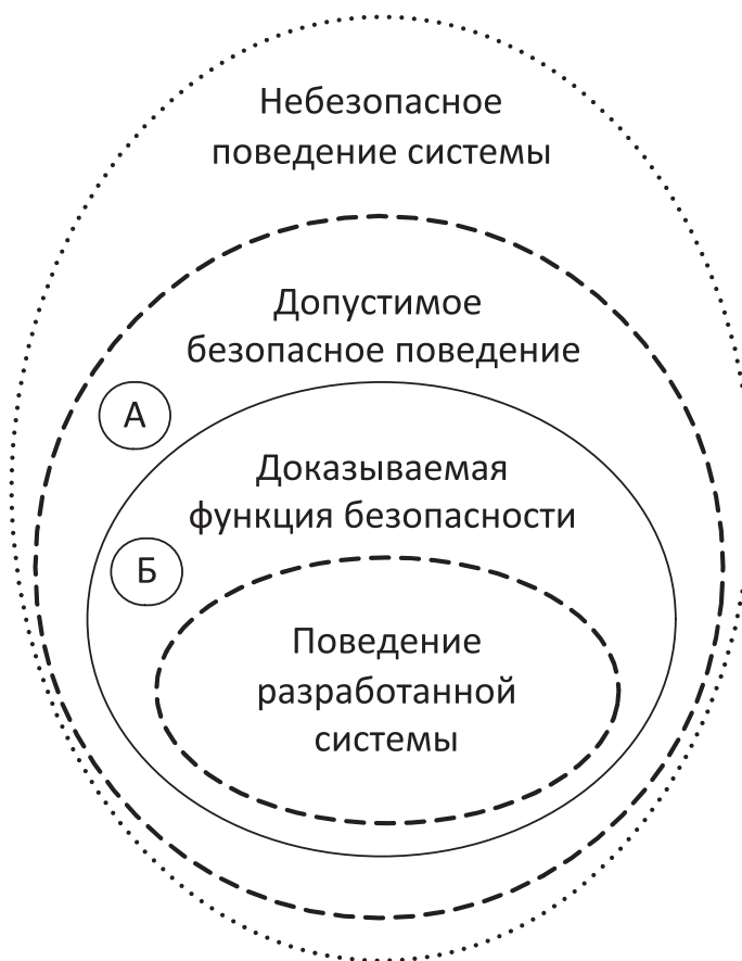
Рис. 2. Выбор доказываемой функции безопасности
