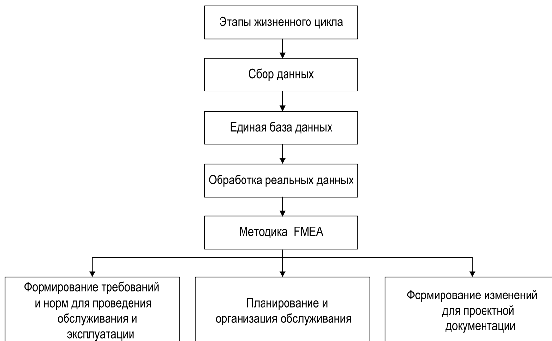
Рис. 1. Структурная модель обеспечения надежности АСУТП
