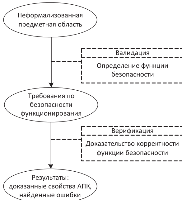
Рис. 1. Последовательность этапов анализа на безопасность
