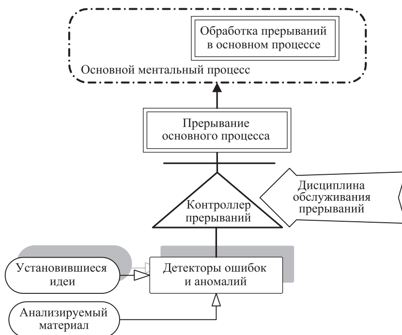
Рис. 2. Структурная организация обработки экспертного знания с прерываниями при обнаружении ошибок и аномалий
