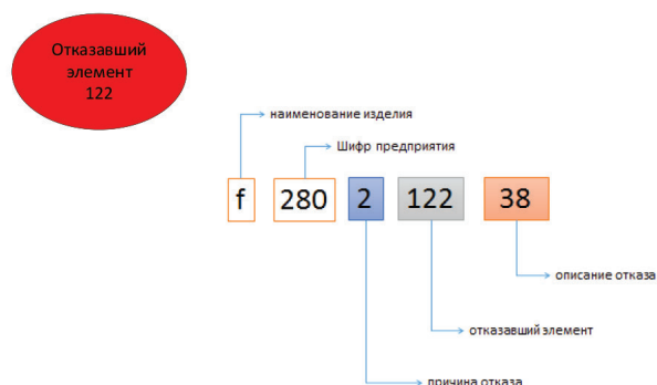
Рис. 7. Кодификация неисправности на примере поворотной подножки
