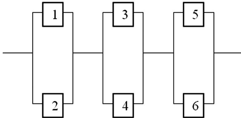
Рис. 3. Последовательно-параллельная система
