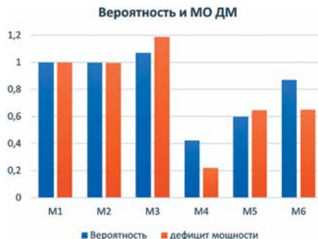
Рис. 1. Вероятность и МО дефицита мощности по отношению к методу М1: М1 – полная свертка ВР генерации; М2 – метод Грам-Шарлье с выделением одной группы; М3 – метод Грам-Шарлье для всех групп генераторов; М4 – Эквивалентирование суточного графика нагрузки нормальным распределением; М5 – эквивалентирование группой эквивалентных генераторов; М6 – эквивалентирование с выделением наиболее мощных генераторов
