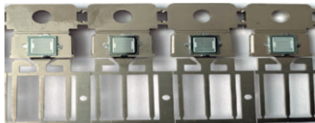
Рис. 1. Посадка кристалла на основание корпуса
