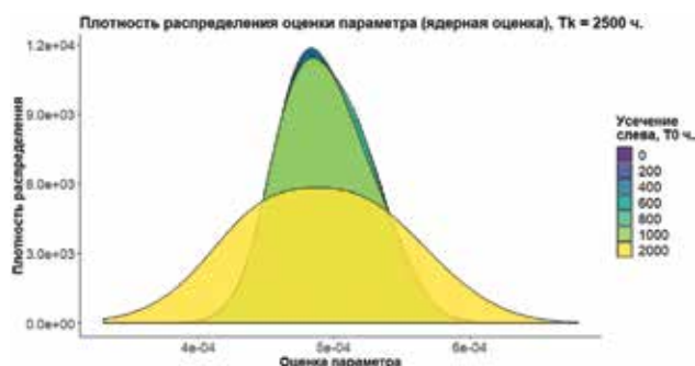
Рис. 8. Результаты оценки параметра интенсивности отказа распределения Вейбулла методом МФР в зависимости от момента начала наблюдения T_0 . T_k = 2500 ч.
