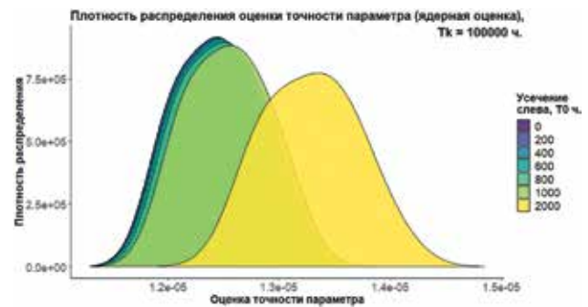
Рис. 3. Результаты оценки точности параметра интенсивности отказа распределения Вейбулла методом МФР в зависимости от момента начала наблюдения T_0 . T_k = 100000 ч.
