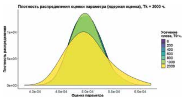
Рис. 6. – Результаты оценки параметра интенсивности отказа распределения Вейбулла методом МФР в зависимости от момента начала наблюдения T_0 . T_k = 3000 ч.
