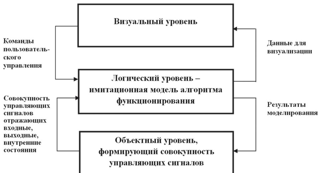
Рис. 1. Архитектура цифрового двойника
