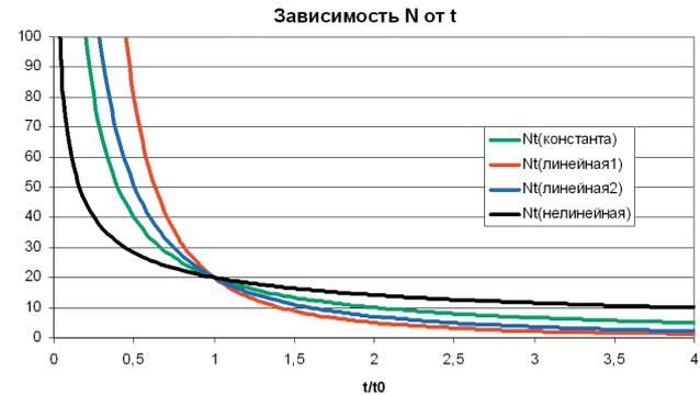
Рис. 2. Зависимость объема испытаний от длительности эксперимента
