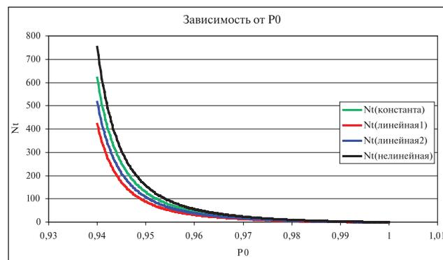
Рис. 1. Зависимости объема испытаний от  $P_0$ .
